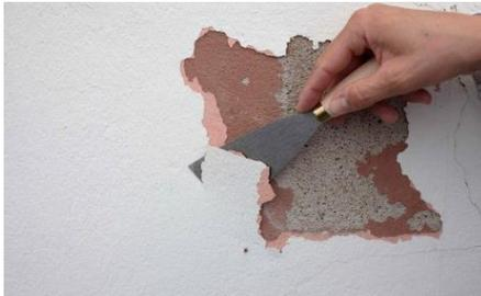
Mit dem Spachtelmesser wird die Adhäsion des Beschichtungsaufbaus auf dem Untergrund durch **Kratzen** geprüft.
