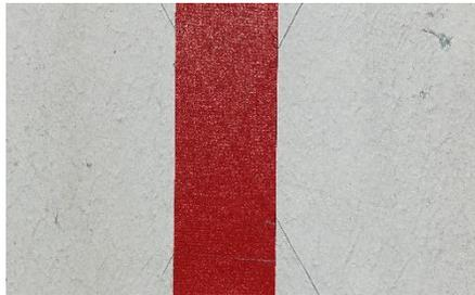
**Klebeband-Abriss** zur Adhäsionsprüfung der Altbeschichtung. Klebeband auf den Kreuzschnitt kleben und fest andrücken – schnell abreißen
