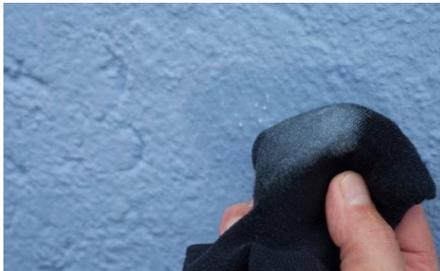
Bei Kontakt mit Lösemittel, zum Beispiel Nitro-Verdünnung, schmiert die Oberfläche.
