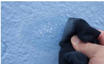
Der „Schmierfilm“ lässt sich abwischen. Polymerisatharz-Farben lösen sich schnell an und sind mit diesem Test gut zu ermitteln.
