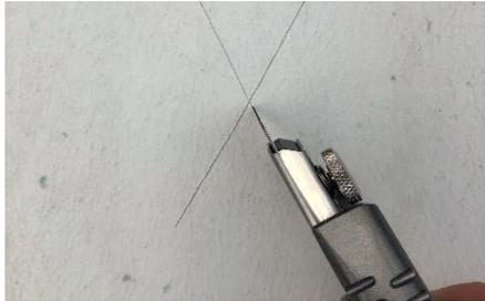
**Kreuzschnittprobe:** Zur Beurteilung der Altbeschichtung mit dem Cuttermesser ein X in die Beschichtung bis zum Untergrund schneiden.
