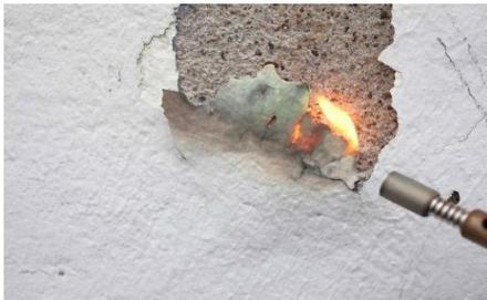
**Flammprobe:** Etwas Beschichtung vom Untergrund lösen und vorsichtig mit dem Bunsenbrenner anzünden. Organische Beschichtungen brennen und lassen sich grob im Geruch unterscheiden.
