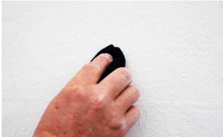
**Wischprobe** zur Feststellung der Kreidung. Mit der Hand oder mit einem dunklen Lappen bei hellen Farben.
