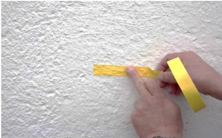
**Klebeband-Abrissprobe** zur Adhäsionsprüfung der Altbeschichtung. Gewebeklebeband aufkleben, fest andrücken und
