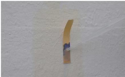
Nach Reinigung der Prüffläche kann die **Alkalität mit Indikatorpapier** gemessen werden.
