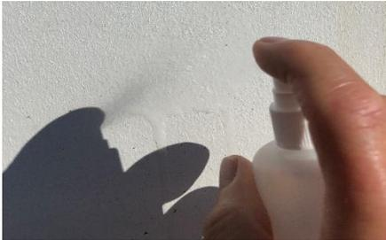
**Benetzungsprobe:** Zur Feststellung der Saugfähigkeit Wasser auf die Oberfläche sprühen.
